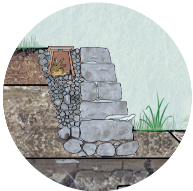
Muro in pietre a secco e cavità
